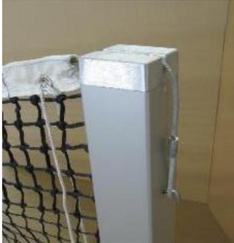
Zunächst das Spannseil oben am Gegenpfosten über die Nut in der Abdeckkappe führen und mit der Öse in den Winkelhaken auf der Rückseite einhängen.
