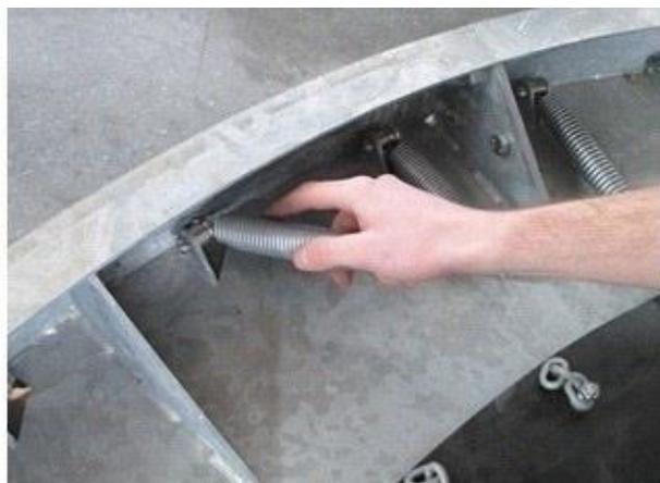
**Hängen Sie die Federn (Pos. 8) mit der Ösenöffnung nach oben zeigend ein.**
