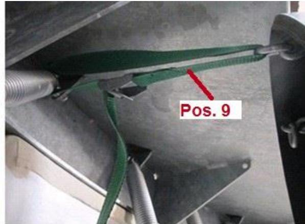
Mit Hilfsmitteln (z.B. Rohre oder Balken) die Sprungmatte zur leichteren Montage der Federn anheben. Membrane mit dem Spanngurt am Federhalter befestigen. Auf der Gegenseite mit der Montage der ersten Feder beginnen.
