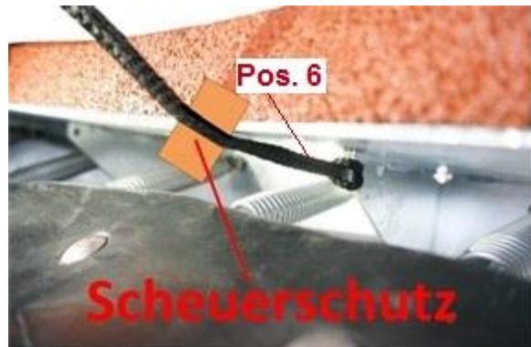
**Hebeseil (Pos. 6) – Montagehilfe für späteren Einbau des Sprungrahmens in die Grube (siehe Seite 19)**
