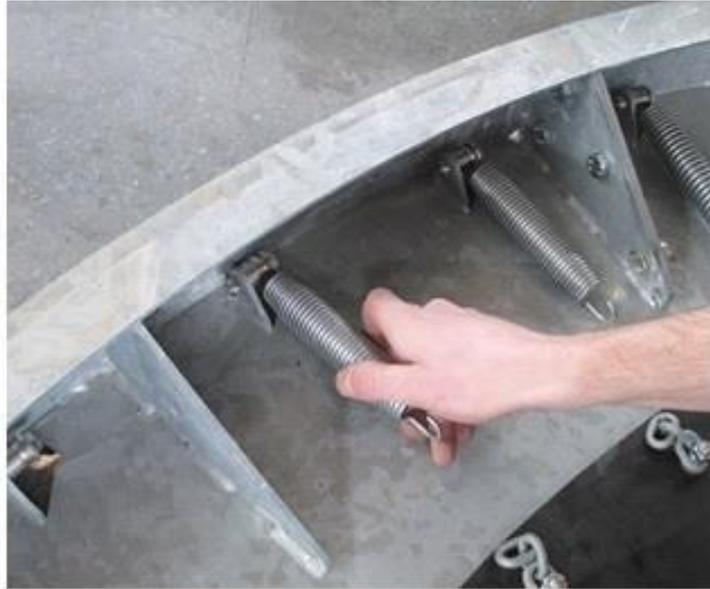
**Die Sprungmatte mit dem Spanngurt an dem Kettenglied und der Federbuchse vorfixieren.
